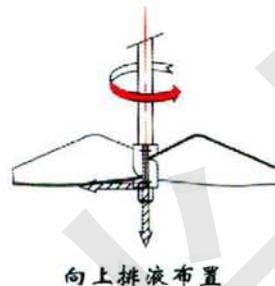
低速搅拌器: 适用于动力黏度 30Pa.s 以下的液体与固体、液体与液体的混合, 构造简单, 安装方便, 经济性好, 减速机输出转速16--160rpm, 广泛用于化工、制药、食品、印染、水处理等领域的液体搅拌。叶轮和轴采用高强度耐腐蚀的316、304不锈钢或碳钢, 也可根据客户需要定做。
