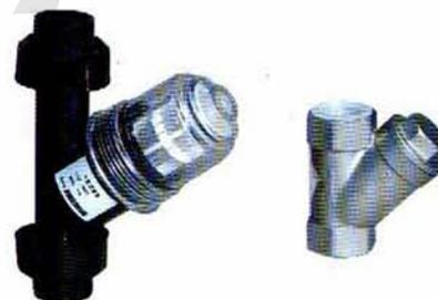
**Y型过滤器：**能过滤介质中的杂质，对计量泵形成保护作用，一般安装在进口管路上并靠近计量泵。
