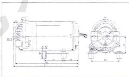
DP-100A、DP-60A型(铁底座、橡胶脚柱)
